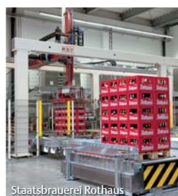
Staatsbrauerei Rothaus RST-Portal-Ent-/Bepalettieranlage mit Paletten-Kontrollstation
